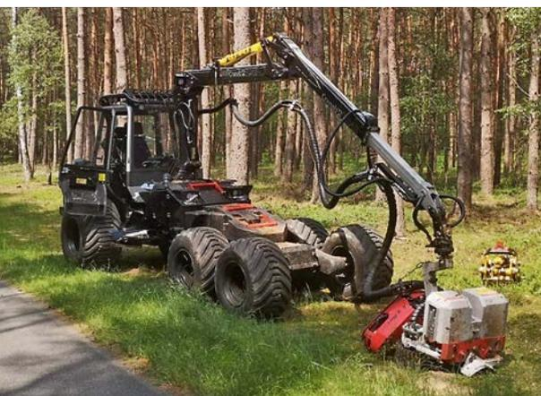
Die Kombimaschine im Harvester-Modus: Stirngitter und Heckteil sind ab-, Zusatzgewichte und Log Max 928A anmontiert.
