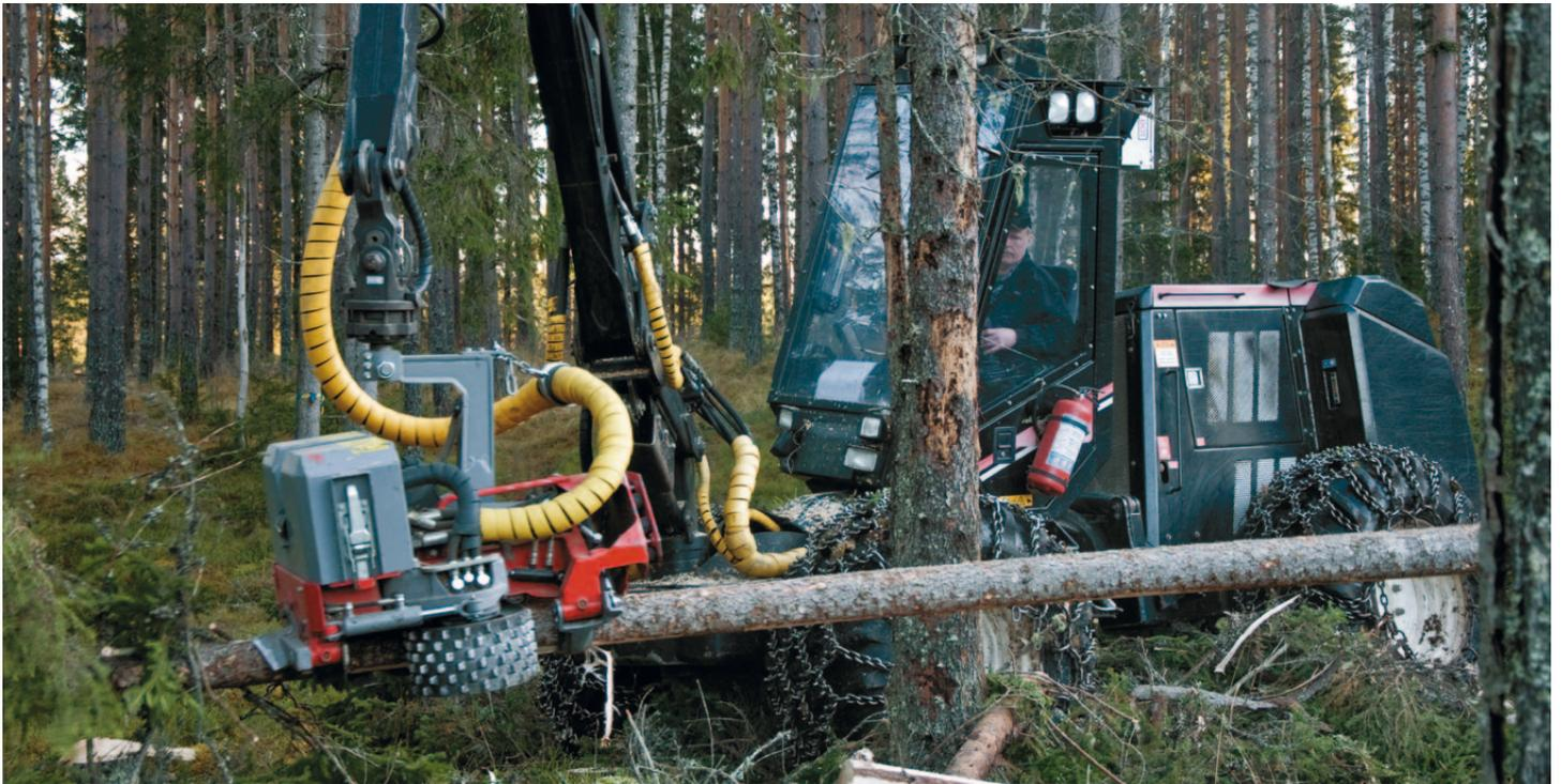
Das Log Max 928 ist ein kleines und leichtes Aggregat spezifisch angepasst für erste Durchforstungen. Durch die kompakte Bauweise ist das Aggregat eine kluge Wahl für kleine Trägerfahrzeuge
